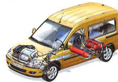
De gastanks zitten ingebouwd in het chassis en nemen dus geen passagiers- of bagageruimte in. (Model: Opel Combo CNG)
